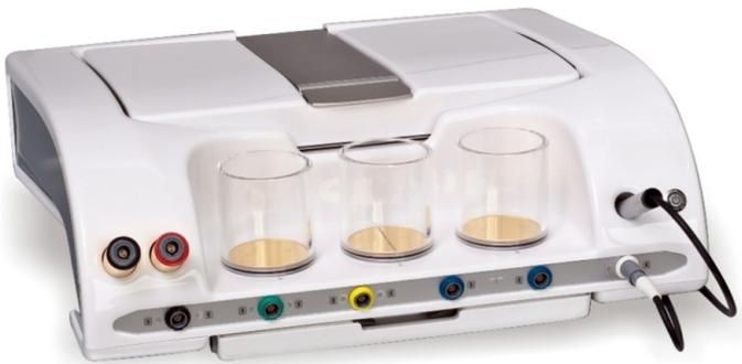
Im Gerät ist ein PC mit aufklappbarem, drucksensitiven Bildschirm eingebaut, wo alle Einstellungen vorgenommen werden können. Es besitzt eine neue Aktivsonde mit UV-Laser-Licht.
